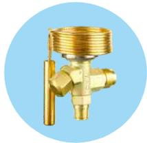
Tiシリーズ温度膨脹弁は温度センサーと外(内)平衡管により蒸発器の輸出の過熱を感知し、蒸発器冷媒の供給量を調整する。
