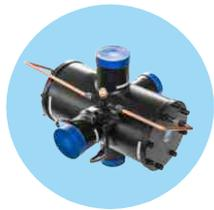
大容量交差式電磁四方切換弁は業務用ヒートポンプ冷却システム、業務用製氷機など広く採用されている。外部のパイロット弁は弁体内の高圧ガスの流れを制御し、ピストン間の圧力差を発生させることによって、ピストンを動かし、ピストンの流路とパイプ接続の組み合わせが変更できる。冷媒の流れを変えることで、冷暖房の切り替えを実現する。
